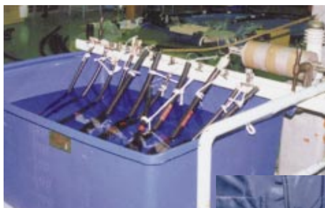
商用周波耐電圧試験状況(水中)
